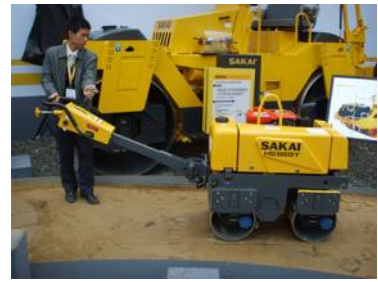
手扶式振动压路机HS66ST 现场演示
